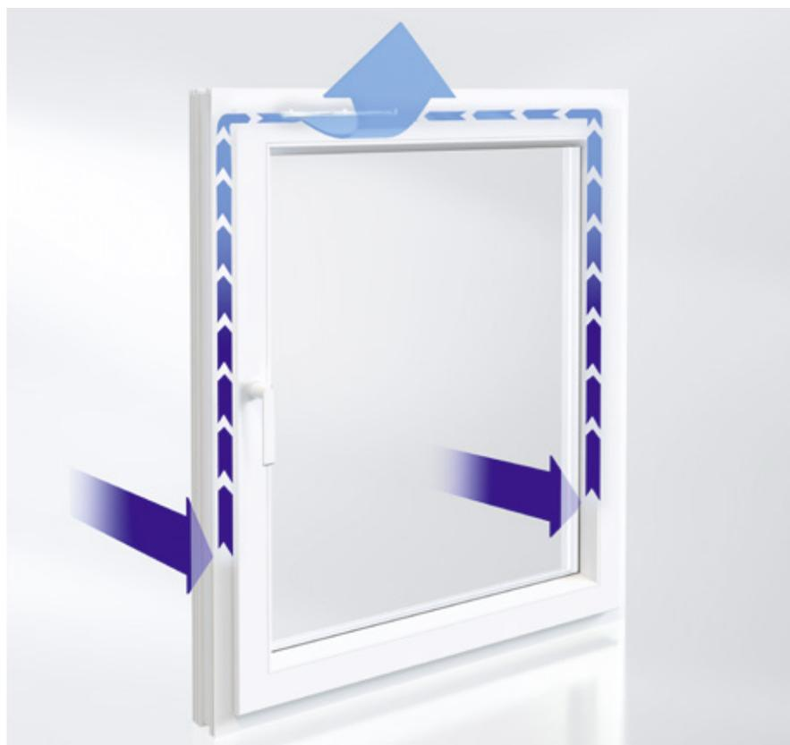
Schüco VentoAir ist ein selbstständig regelnder Fensterfalzlüfter aus Kunststoff mit automatischer Volumenstrombegrenzung zum paarweisen Einsatz für einen kontrollierten Luftwechsel und sichere Entfeuchtung ohne Zugerscheinung. Durch den Lufteintritt im oberen Fensterbereich ist eine ruhige Luftführung im Raum gesichert.
