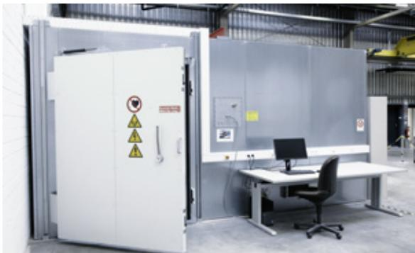
**Elektronikprüfung (EMV und IP-Schutzarten)**
