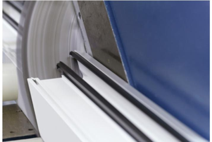
Kunststoff-Profilbearbeitung auf Maschinenteknik mit ionisierter Luft
